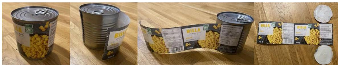
Abbildung 3: Herstellung einer Dose – Materialaufwand (von der Autorin erstellt)
